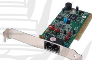
(ข) โมเด็มแบบติดตั้งภายใน
