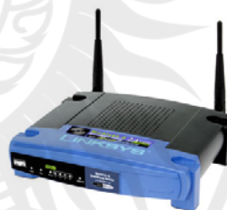
ภาพที่ 1.8 อุปกรณ์จัดเส้นทาง
