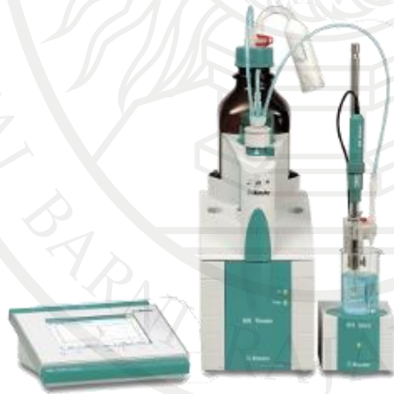
ภาพที่ 5.7 ตัวอย่างเครื่องไทเทรตอัตโนมัติที่ทันสมัยในปัจจุบัน
