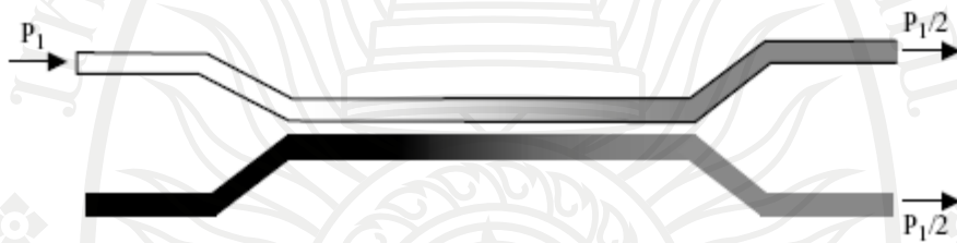
ภาพที่ 7.12 ลักษณะของคัปเปิลเลอร์ -3 เดซิเบล ที่มา: Thyagarajan, K. and Ghatak, A., 2010
