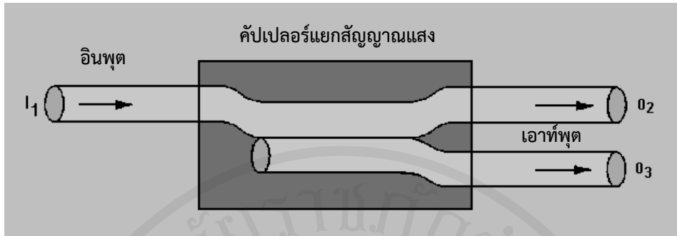
ภาพที่ 7.5 ลักษณะของคัปเปิลเลอร์แยกสัญญาณแสง ที่มา: Integrated publishing, n.d.
