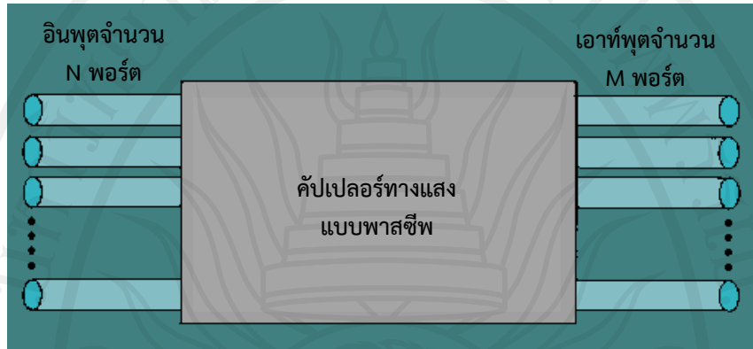
ภาพที่ 7.4 รูปแบบพื้นฐานของอุปกรณ์คัปเปลอร์ทางแสง ที่มา: Integrated publishing, n.d.
