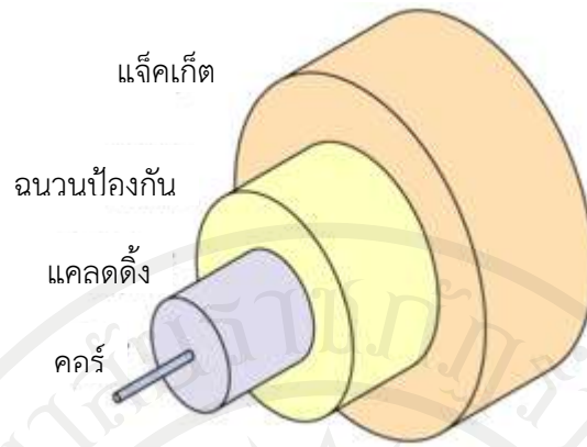
ภาพที่ 2.5 โครงสร้างของเส้นใยแก้วนำแสง ที่มา: Schools wikipedia selection, 2007
