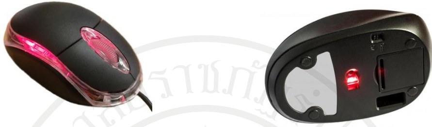
ภาพที่ 1.7 เมาส์แบบแสง ที่มา (Alibaba. n.d.)
