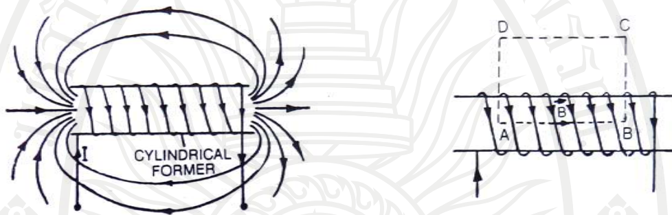
ภาพที่ 3.24 แสดงสนามแม่เหล็กที่เกิดจากกระแสไหลผ่านขดลวดโซลินอยด์
